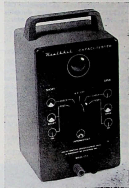
De Heathkit CAPACI-TESTER heeft een professioneel aanzien. De (eenvoudige) schakeling is in een grijs metalen kastje ondergebracht.
